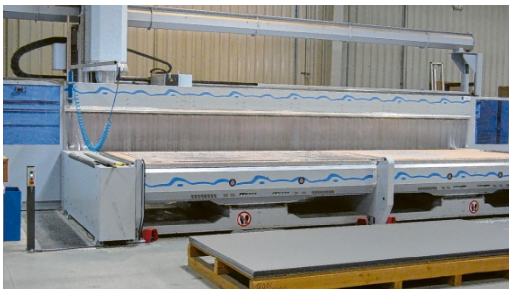
Moderne Bearbeitungsmaschinen der Alu-Leichtbauplatten. Foto: Metawell/oH
