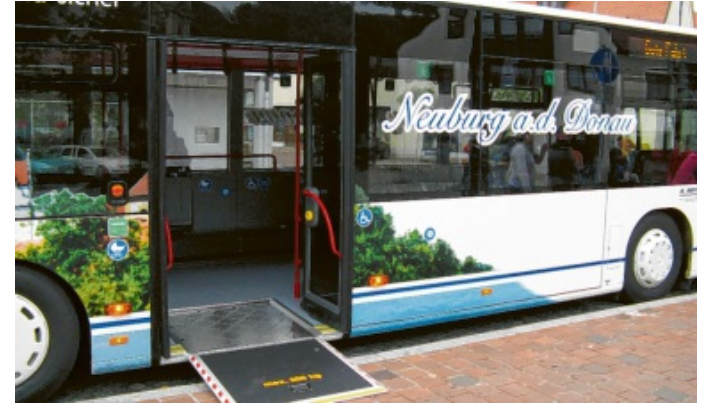
Das Einstiegssystem des Neuburger Stadtbusses ist aus Metawell®-Platten gebaut. Foto: Metawell/oH
