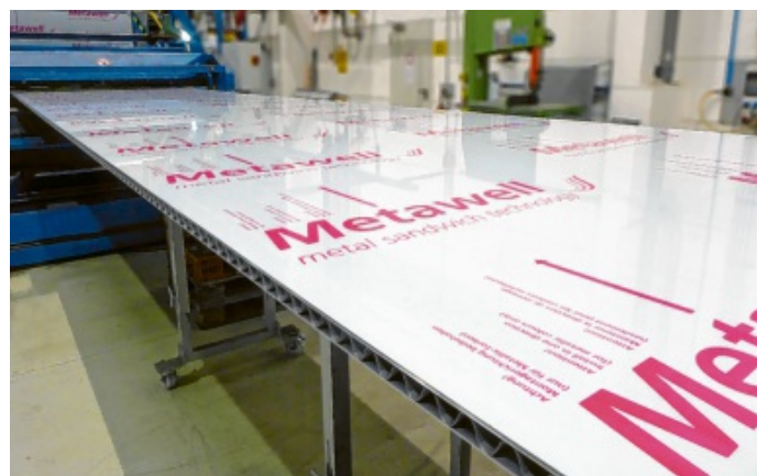
Kontinuierliche Fertigung der Alu-Verbundplatte in Sandwichbauweise Marke Metawell®. Foto: Metawell/oH
