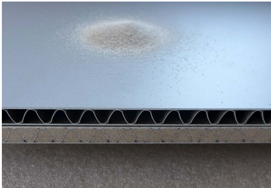
Abbildung 5.2: Aufbau der Schalldämm-Platte „Metawell® Alu-Silent“
