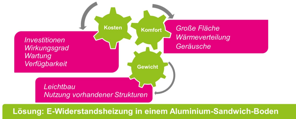
Abbildung 2.1: Vorteile der Fußboden-Widerstandsheizung in Alu-Sandwich-Bauweise
