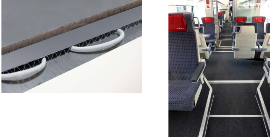
Abbildung 6.2: EC 250 Giruno, Stadler Rail AG, Fahrgastbereich und Parallelheizkabel
