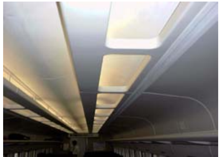
Gekrümmtes Aluflex als Deckenelement im Shinkansen Links: montierbereit Unten: eingebaut
