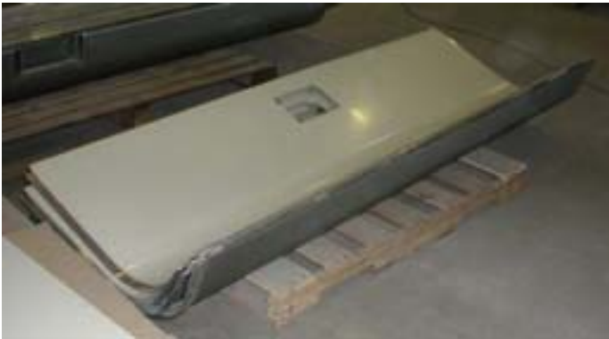
Gekrümmtes Aluflex als Deckenelement im Shinkansen Links: montierbereit Unten: eingebaut
