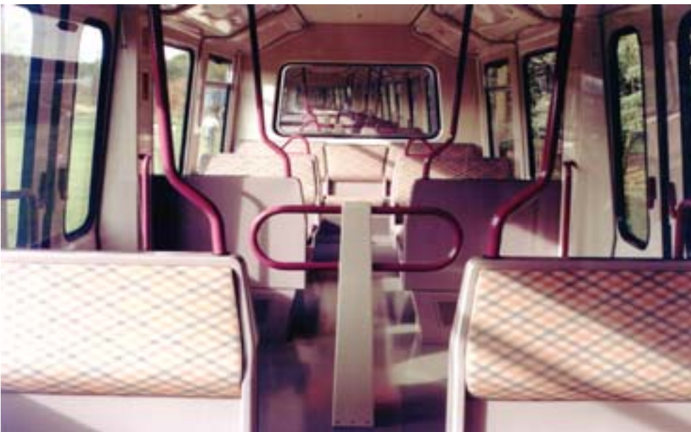
Schutzplatte: unter den Sitzbänken der Hamburger Hochbahn wurde Aluflex eingesetzt
