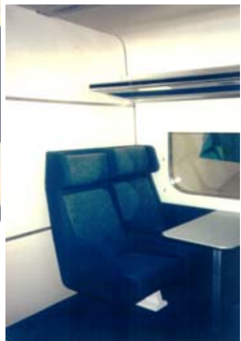
Gekrümmtes Aluflex als Deckenelement für ASCAN Oben: Montage Rechts: eingebaut
